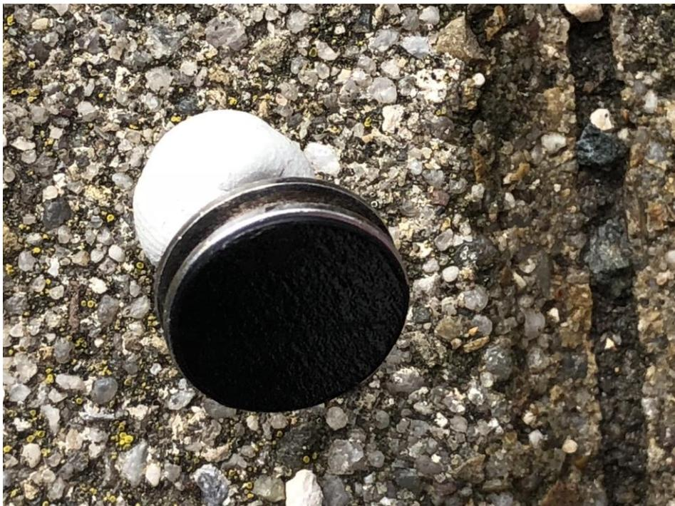
Folie wird abgezogen und der Probenträger mit Klebegummi am entsprechenden Ort positioniert
