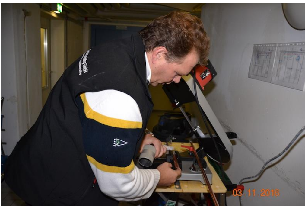
Bild 6: Überprüfung der fachgerechten Entgratung durch Inaugenscheinnahme und Tasten
