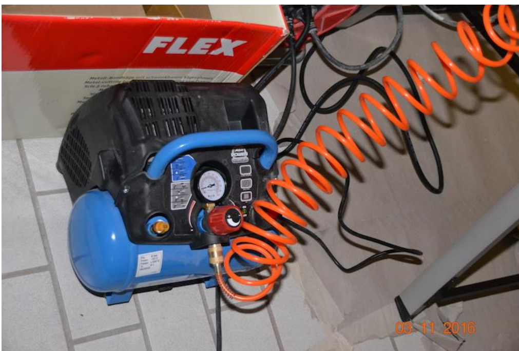
Bild 8: Bei Trinkwasser-Installationen darf eine Dichtheitsprüfung mit Luft nur ölfrei oder mittels Inertgas nach DIN EN 806-4:2010-06 erfolgen. Ergänzt wird diese Norm durch die VDI/DVGW 6023 und dem ZVSHK Merkblatt "Dichtheitsprüfungen von Trinkwasser-Installationen mit Druckluft, Inertgas oder Wasser"
