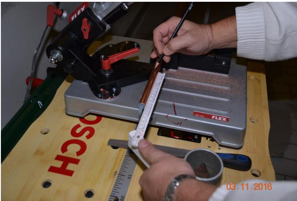
Bild 2: Anzeichnen des Sägeschnittes
