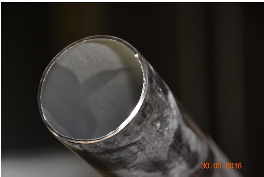
Bild 11: Edelstahlrohr, hier: Nicht fachgerecht ausgeführte Entgratung
